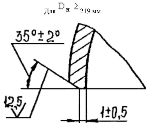
Примечание - Для отводов  $D_n = 57$  мм допускается торцовка без разделки кромок.
